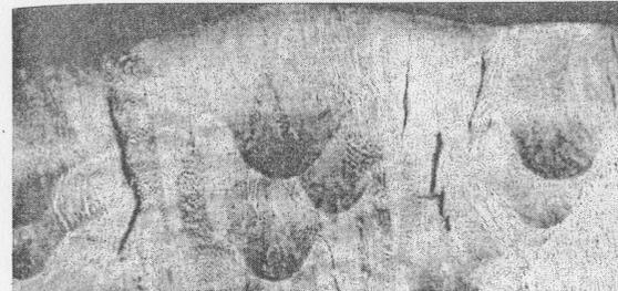
(d) 多層溶接部のマイクロ割れ (高温割れ) (オーステナイト合金).
